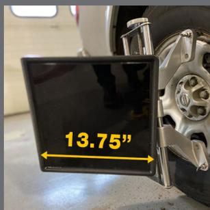
Las cámaras de imagen Dimensión 4 obtienen lecturas de los targets de alta resolución montados en cada rueda. En el interior de los objetivos hay "espejos" de alta precisión que, se fabrican utilizando una tecnología de impresión de última generación, que ofrece una resolución insuperable para una precisión extremadamente alta. Cada target está montado en un adaptador de abrazadera autocentrante de aluminio ligero y duradero con un rango de ruedas de 12" a 24".
